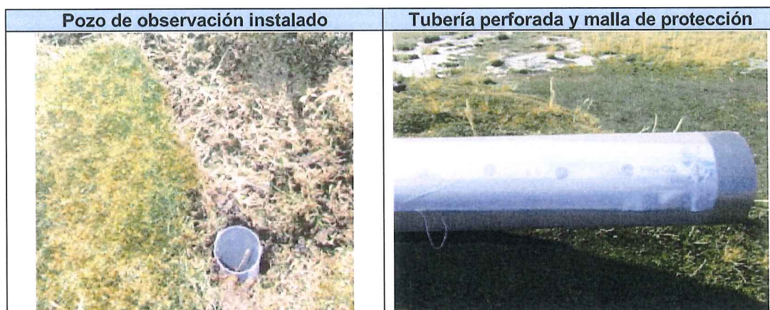
Figura 38 Características de los pozos de observación para la medición de la napa freática
