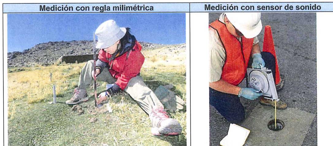
Figura 37 Tipos de medición para los pozos de observación según la profundidad
